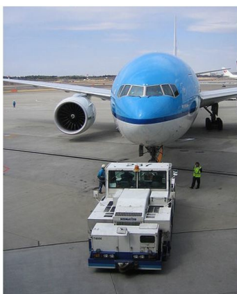
A imagem acima representa um serviço de pushback (fonte: https://en.wikipedia.org/wiki/File:KLM_777_pushback.jpg )
